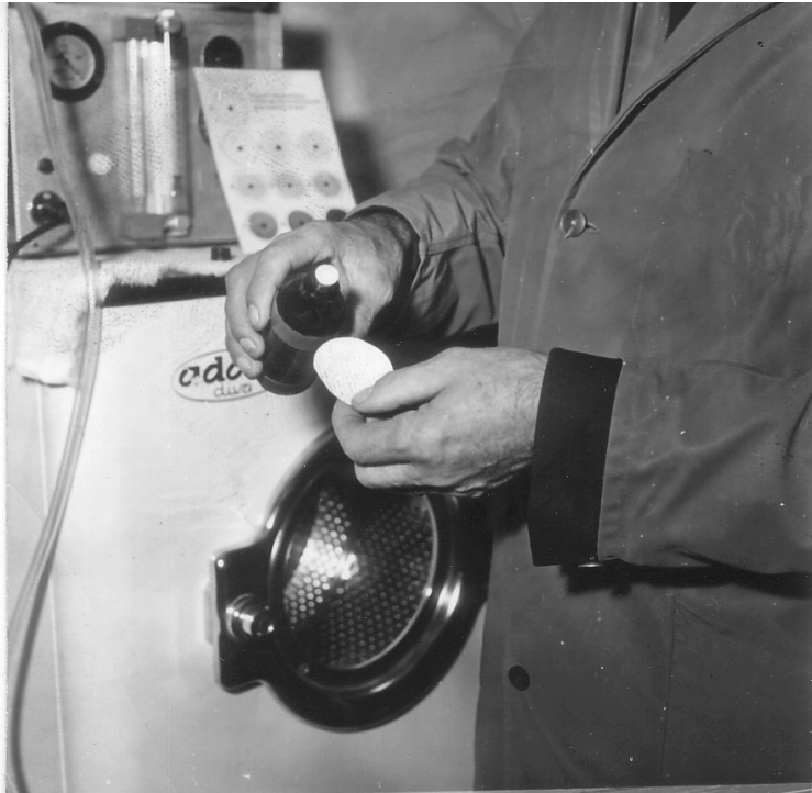
Nach der Messung wurde kontrolliert, ob unverbranntes Öl durch den Kamin entweicht.
